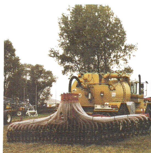
L'injection du lisier dans le sol
